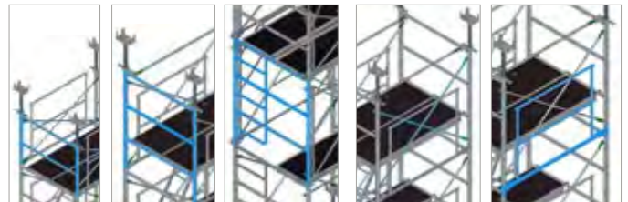
Cadre STAFLEX acier 92.5 Cadre STAFLEX acier 150 Cadre STAFLEX acier échelle intégrée 150 Diagonale croisillon Lisse garde-corps connecteurs BIVA
