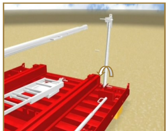
12 - Déployer les contre fiches de leurs emplacements de colisage.
