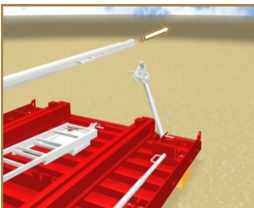
11 - mettre en place l'étau de plombage à l'arrière de la Plateforme et l'ajuster.
