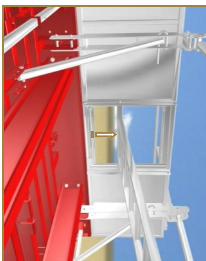
17 - Positionner l'échelle en position de travail. - Vérifier le goupillage de l'axe de l'échelle. - Insérer le second axe de l'échelle et la goupille \phi après ajustement de sa longueur.
