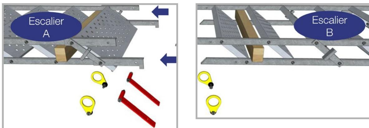
**3** Une fois en place mettre les vis d'assemblage, puis serrer.
