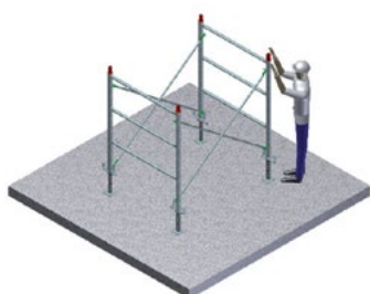
4 POSITIONNER 4 CONNECTEURS en tête des cadres.
