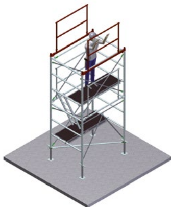
7 DEPOSER les 2 LISSES GARDE-CORPS CONNECTEURS BIVA
