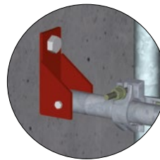
Tube Ø 48.3 x 3.2 équipé d'une chape articulée fixée au mur par une cheville à béton.
