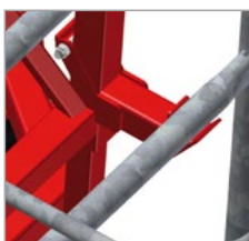
Le GUIDE MOBILE BAS du chariot est passé SOUS UN BARREAU du cadre STAFLEX (réglage possible).
