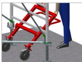
Le GUIDE BAS du chariot est passé SOUS UN BARREAU du cadre STAFLEX.
