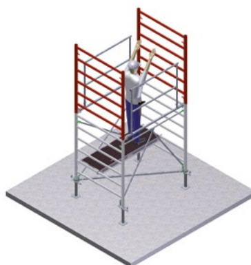
8 DEPOSER les 2 CADRES STAFLEX ALUMINIUM EI 150.
