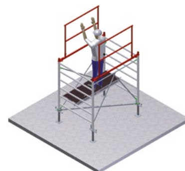
9 DEPOSER les 2 LISSES GARDE-CORPS CONNECTEURS BIVA.
