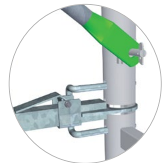
8 VERROUILLER les 2 LISSES GARDE-CORPS CONNECTEURS BIVA.
