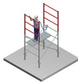
6 FIXATION EPI /POSITIONNER 2 CADRES STAFLEX ACIER 150.
