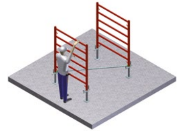
3 POSITIONNER 2 CADRES STAFLEX ALUMINIUM EI 150.
