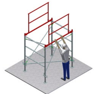
5 POSITIONNER 2 LISSES GARDE-CORPS CONNECTEURS BIVA.
