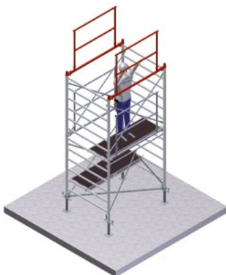
11 POSITIONNER 2 LISSES GC CONNECTEURS BIVA.
