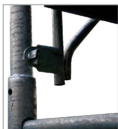
Système d'accrochage inférieur des garde-corps à verrouillage automatique
